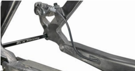
Abb. Bremsleitungsverlegung am Hinterrad, Magura
