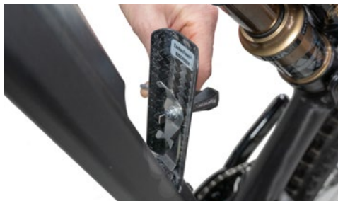
Abb. zum Schliessen richtig eingedrehtes Federblech
