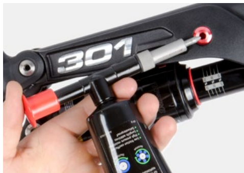
Abb. zeigt: Abschmierbare Lagerstelle am Oberrohr
