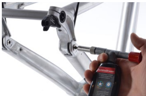
Abb. zeigt: Abschmierbare Lagerstelle
