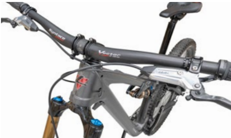
Abb. Bremsleitungsverlegung vorne links
