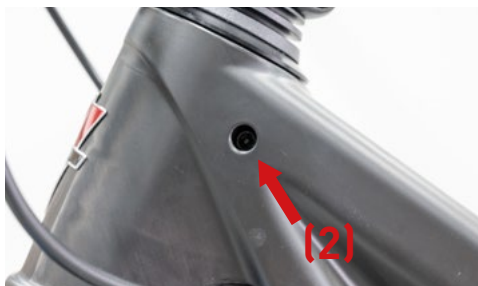
Abb. Rahmenöffnung und Nockenfeststellschraube
