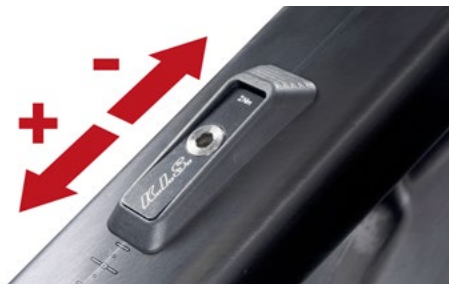
Abb. Einstellrichtungen der K.I.S. Vorspannung
