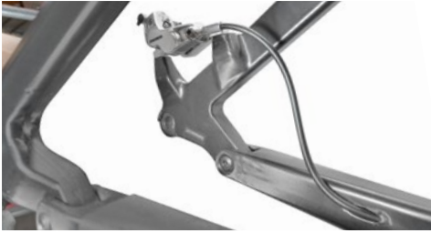
Abb. Bremsleitungsverlegung am Hinterrad, SRAM
