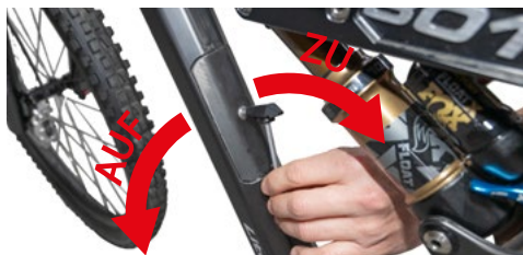
Abb. Öffnen des Staufachs mit X-Fix
