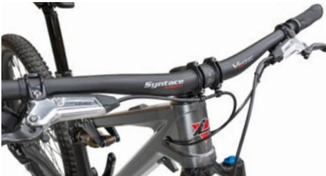
Abb. Bremsleitungsverlegung vorne rechts
