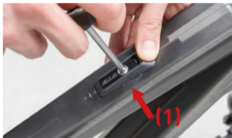
Abb. Einstellung der K.I.S. Vorspannung
