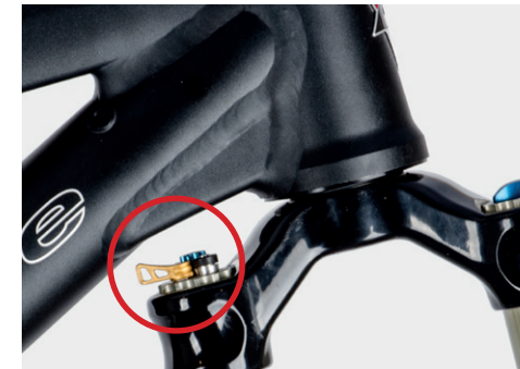
Abb. Freiraum zum Unterrohr
