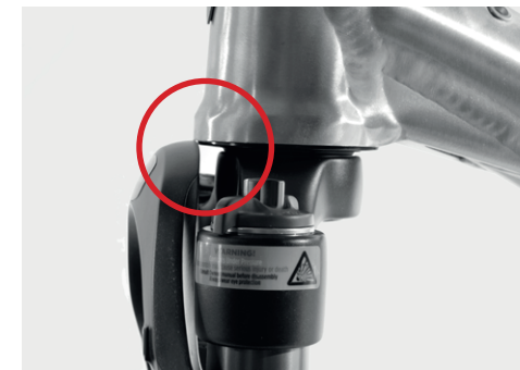
Abb. Freiraum zum Steuerrohr
