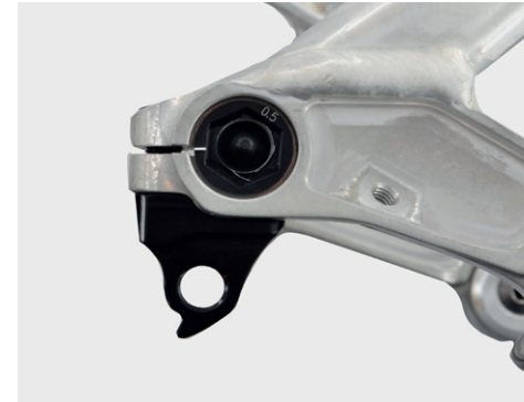
Abb. zeigt: Insert mit Klemmschlitz korrekt ausgerichtet
