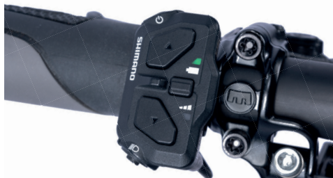
Abb.: Ein- / Ausschalter und Unterstützungsmodi-Schalter
