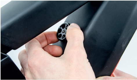
Abb.: Lösen der Zentralschraube bei den Größen M, L, XL.
