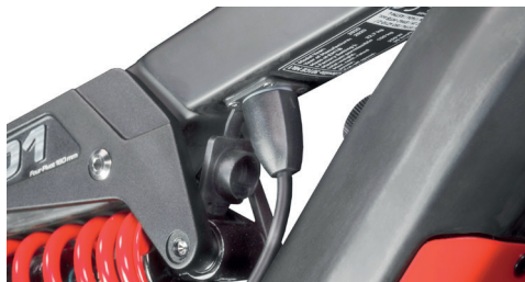
Abb.: Ladebuchse beim 301CE Mk2
