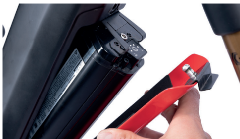
Abb.: Entfernen des Akkudeckels
