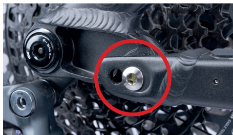
Abb.: Abschmierbare Lagerstelle am Horstlink
