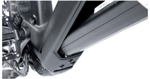
Abb.: Einstecken des Akkus
