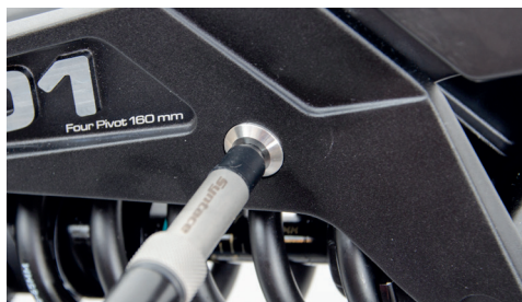
Abb.: Abschmierbare Lagerstelle am Oberrohr
