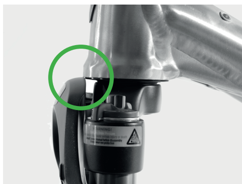
Abb. Freiraum zum Steuerrohr
