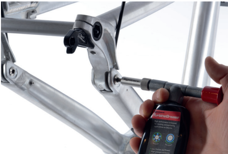
Abb. zeigt: Abschmierbare Lagerstelle am Horst-Link
