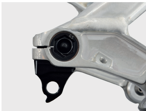
Abb. zeigt: Insert mit Klemmschlitz korrekt ausgerichtet
