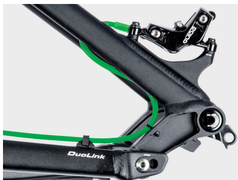
Abb. zeigt Bremssattel auf PM mit Leitungsabgang SRAM
