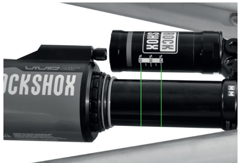
Abb. zeigt SAG ablesen am Dämpfer
