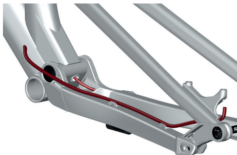
Abb. zeigt die Zugverlegung der Bremsleitung
