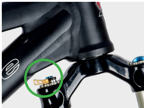
Abb. Freiraum zum Unterrohr
